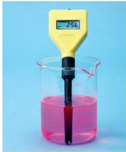
le pH-mètre est un appareil comportant une sonde et un système électronique de mesure pour déterminer la valeur de pH avec plus de précision.
